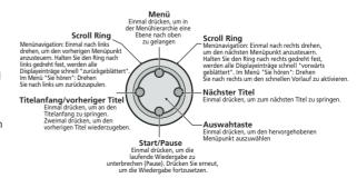
Drive + Play funktioniert ganz ähnlich wie der iPod selbst. Der Steuerknopf imitiert das Click Wheel des iPod, und die Software benutzt ein ähnliches System zur Menüauswahl. Bevor Sie Drive + Play zum ersten Mal benutzen, müssen Sie zunächst eine Erstkonfiguration vornehmen (siehe weiter unten).
